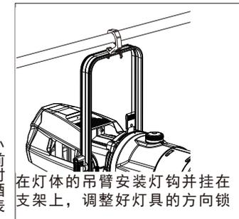
在灯体的吊臂安装灯钩并挂在支架上，调整好灯具的方向锁
